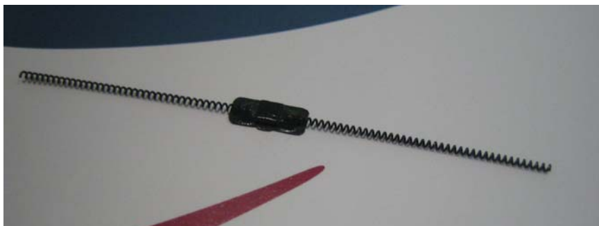
Figur 2: En annan typ av RFID-tag, möjlig att använda för identifiering av byggmaterial. Längd ca 40 mm.
