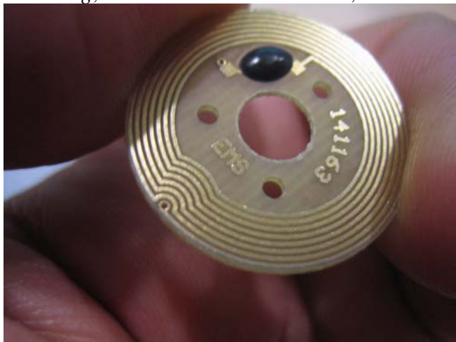
Figur 1: RFID-tag av den typ som används för identifikation vid tillverkning av dörrar på Swedoor.
